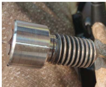
รูปภาพแสดงชุด Mixer Assembly ของ Flare Stack V-9801
