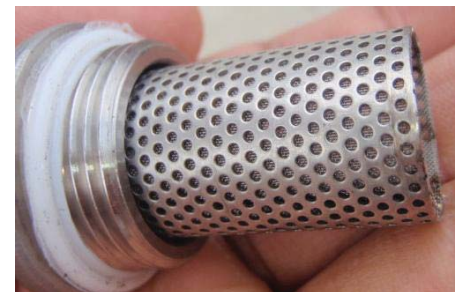
รูปภาพแสดง Strainer ของ Flare Stack V-9801
